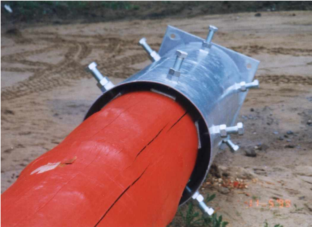
Bild 4. Rohrhülse, Durchmesser 61 cm mit Stellschrauben M 36 Fig.4. Tube sleeve, diameter 61 cm with M 36 set screws
